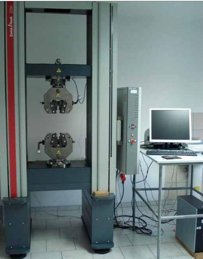
U vlastitoj laboratoriji u Begovom Hanu, VELBOS d.o.o. testira mehaničke karakteristike svojih proizvoda, i to u svim proizvodnim fazama, a kupcu daje kompletну atestnu dokumentaciju, čime garantuje kvalitet za svaki svoj proizvod. Mehanička ispitivanja vrši stručno osoblje u skladu s međunarodnim standardima.
