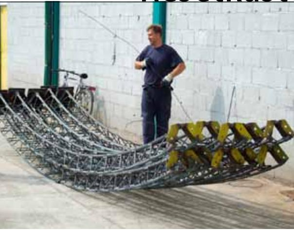
Izgradnja tunela predstavlja zahtjevan interdisciplinaran građevinski zahvat, vrlo specifične građevinske materijale i proizvode. VELBOS d.o.o. proizvodi **rešetkaste** tunelske podgrade koji su testirane i uspješno ugrađene u mnogim tunelima u BiH i u regionu. Suprotno od standardnih tunelskih podgrada koje su napravljene s punim profilima, Velbosove **rešetkaste** tunelske podgrade u kombinaciji s mlaznim betonom formiraju cijelovitu homogenu kompozitnu strukturu.
