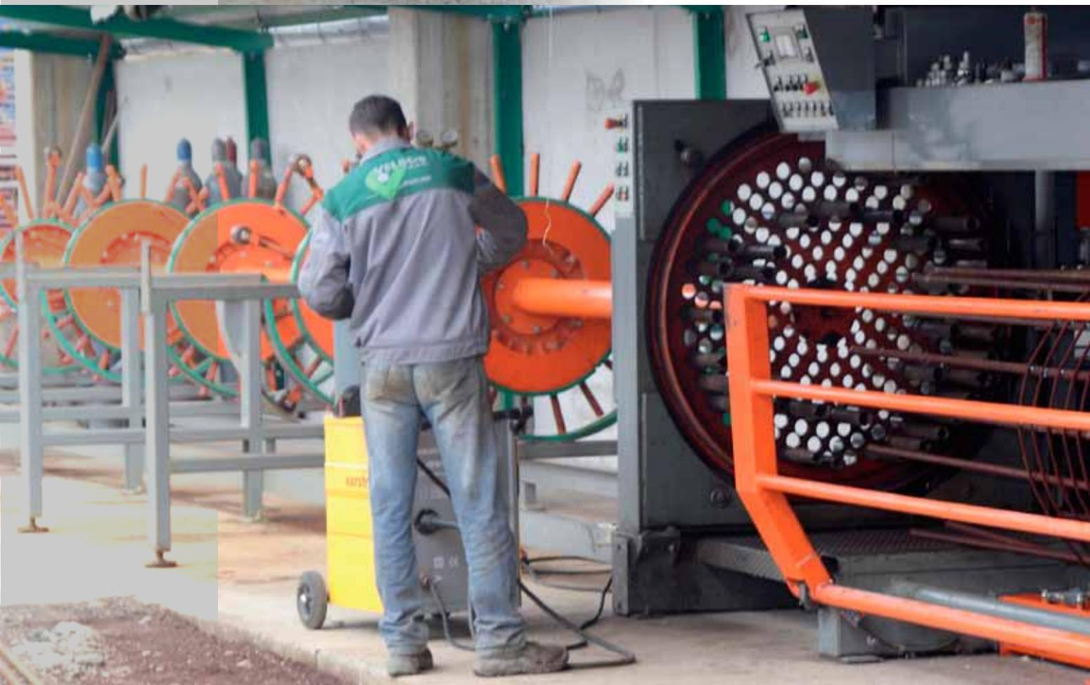
VELBOS d.o.o. ima izgrađenu posebnu automatsku liniju za industrijsku proizvodnju armturnih koševa za betonske šipove od rebrastog betonskog čelika. Kvalitet čelika garantuje "ARCELOR MITTAL" kvalitetom B500B a «Robot GTM xp» marke «SCHNELL and GRICOR» zavaruje i savija čeličnu žicu prema zahtjevima kupaca, što ovom proizvodu daje status «specijalnog proizvoda» "VELBOS-a" koji garantuje vrhunski kvalitet.
